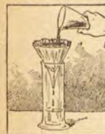
91. Después se filtra el guarapo con carbón animal*; el líquido filtrado pierde el color, convirtiéndose en un jarabe limpio que se evapora; de este modo se obtiene azúcar mascabado (en bruto), que se refina luego para hacerlo blanco.
