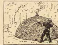
25. Carbonero amontonando leña para fabricar carbón: se deja una galería horizontal que comunica con una chimenea, y el montón se cubre con tierra húmeda. Se verifica esto en los mismos bosques donde se corta la madera.
