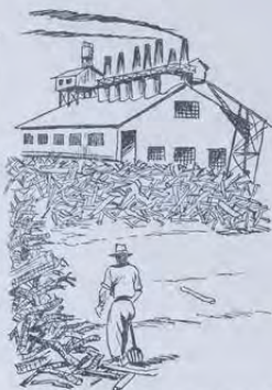
Hornos donde se transforma la piedra caliza en cal viva.
