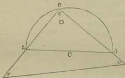
de la escuadra FEG sobre el ADB de manera que el vértice E coincida con D y el lado EF con DA. Si el lado DG de la escuadra toma la dirección DB la escuadra será buena; en caso contrario será defectuosa.
