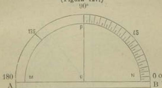
de cobre ó asta. Su *limbo* ó borde exterior está dividido en  $180^\circ$  grados y cada uno de estos en medios grados, terminando en el diámetro AB en cuyo punto medio hay una pequeña hendidura que se llama *centro del transportador*.
