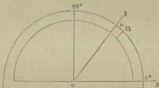
y la 52, se apreciará a simple vista su distancia a la primera de estas divisiones y si se aprecia en  $\frac{1}{4}$  de una división, se dirá que el ángulo A O B es de  $51^\circ 45'$ .
